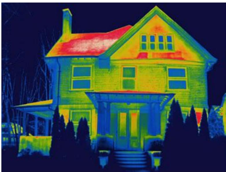
Image infrarouge montrant la déperdition de chaleur d'un bâtiment. [Source.](#)
