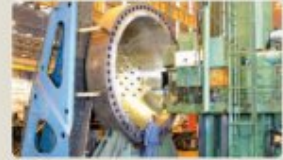
Usinage d'un couvercle de cuve
