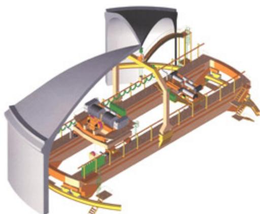
*Pont polaire du réacteur EPR en construction en Finlande*
