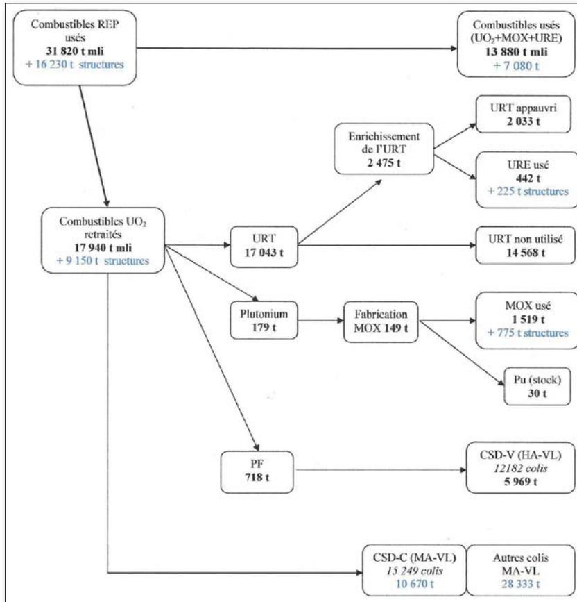
Figure N° 2 : État du cycle électronucléaire en 2012
