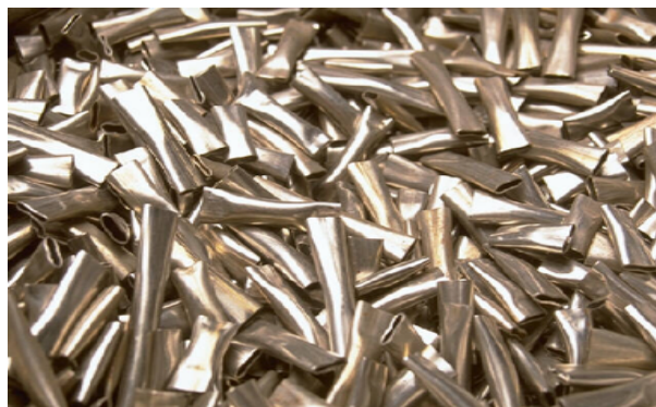
Figure 2 : Entreposage des coques en vrac dans le silo HAO
