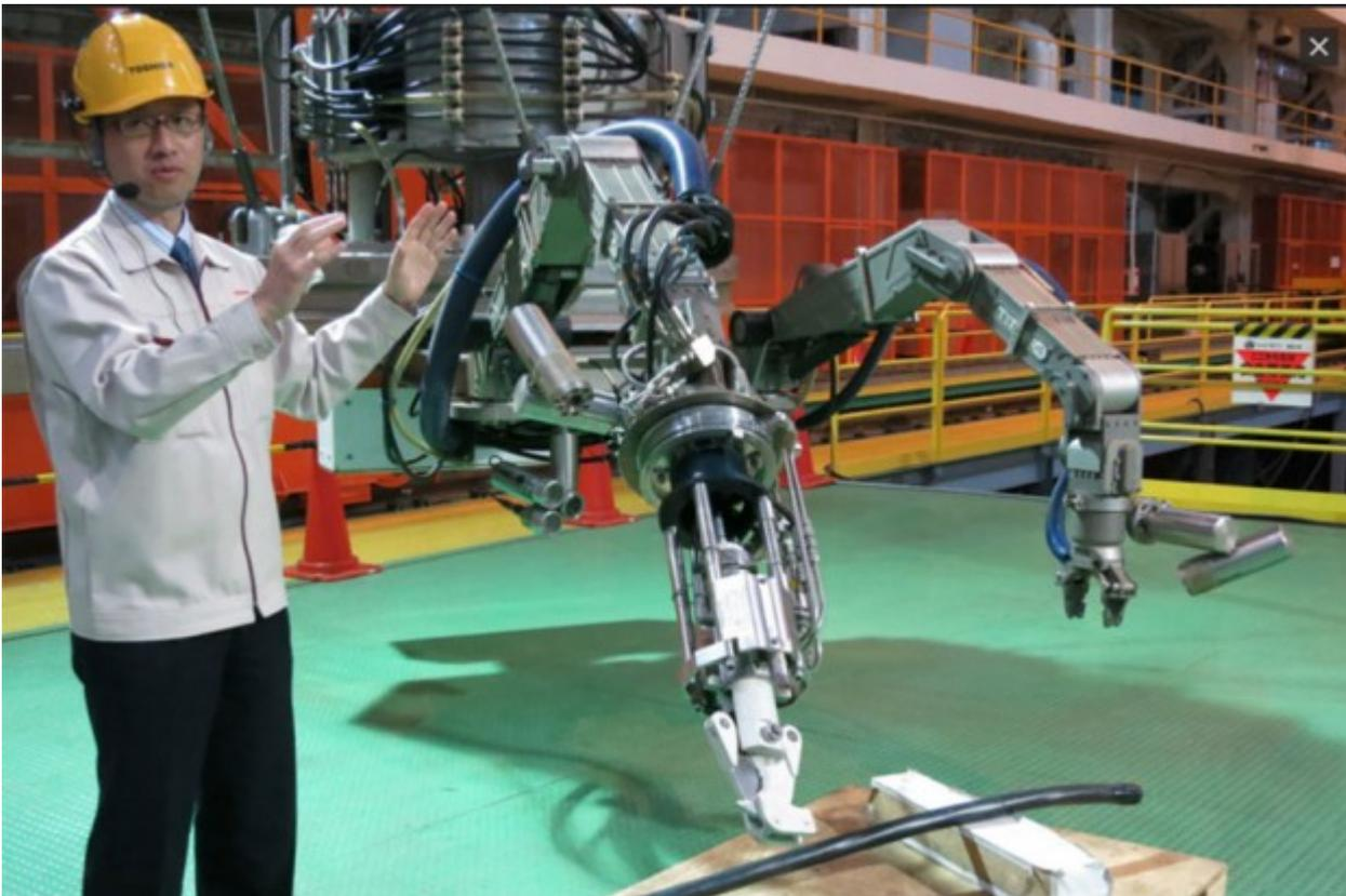
Robot Toshiba conçu pour extraire les barres de combustible des piscines de refroidissement - résistera-t-il plus de quelques heures aux conditions infernales ?
