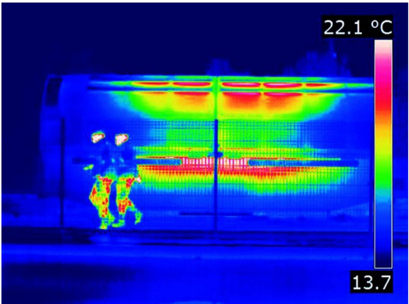
Photo d'un wagon CASTOR du convoi Sellafield - Bâle prise à la caméra thermique. Malgré le blindage des "colis" radioactifs, la caméra détecte bien un dégagement thermique. Par ailleurs, un cheminot ou un policier stationnant 30 minutes au contact d'un wagon CASTOR reçoit l'équivalent de la dose annuelle autorisée !
