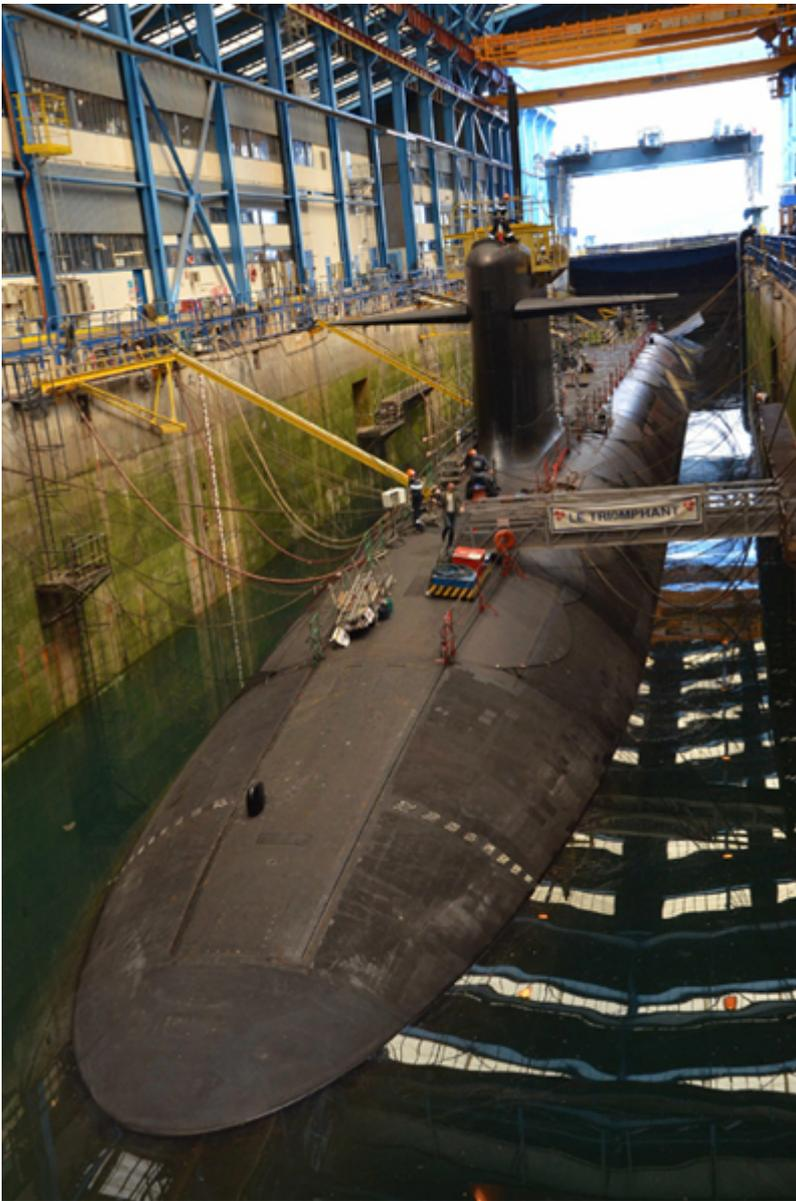
*Photo : Un SNLE (sous-marin nucléaire lanceur d'engins) à quai dans la base de l'Île Longue.*
