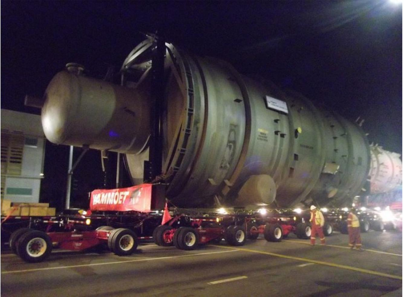
*Photo : un convoi exceptionnel transporte une cuve de réacteur nucléaire, qui pèse plusieurs dizaines de tonnes. Une fois en service, elle sera constamment soumise à des radiations massives et des températures de plusieurs centaines de degrés, entraînant progressivement sa fragilisation.*
