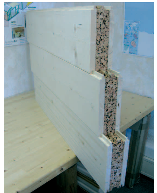
Le Sapiliège SL 86 est un panneau sandwich constitué successivement de liège et d'èpicéa. Il est destiné à la réalisation de cloisons (porteuses), planchers (porteurs) et plafonds. Il se pose à joints perdus comme le parquet. (Simonin Frères)
