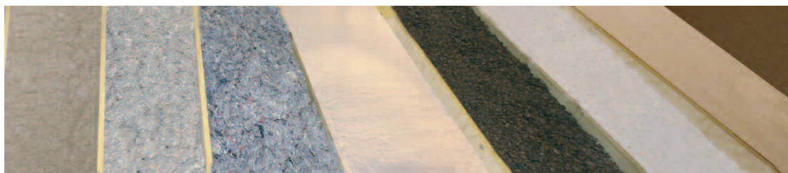
Isolants naturels ou issus du recyclage : de gauche à droite, le chanvre, la ouate de cellulose en vrac, le textile recyclé, le coton recyclé, le liège en vrac, la perlite, la fibre de bois.
