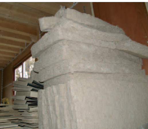
Les isolants en fibres naturelles sont respirants (pas de condensation), réclament peu de transformation pour leur fabrication et leur transport (donc d'énergie) et sont sains (pas d'émanation toxiques).
