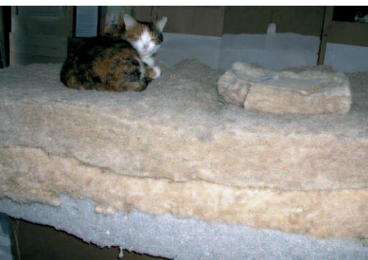
Les isolants en fibres naturelles sont respirants (pas de condensation), réclament peu de transformation pour leur fabrication et leur transport (donc d'énergie) et sont sains (pas d'émanation toxiques).
