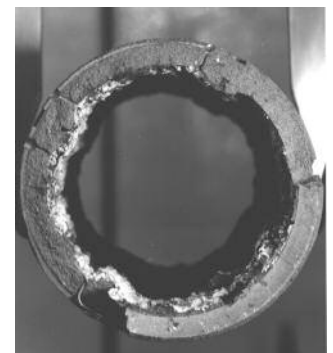
Chemise de graphite après fusion complète de l'élément combustible (Photo : JFF)
