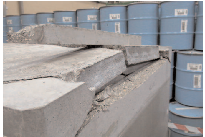
Couvercle détruit sur CBF-K, démantèlement UNGG (Photo : CB)
